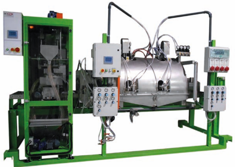
Modulo compatto con applicazione MULTICOLOR a 4 colori ed essiccatoio elettrico Compact unit with MULTICOLOR application at 4 colours and electric dryer Компактный блок с системой MULTICOLOR на 4 цвета и электрической сушкой Módulo compacto com sistema MULTICOLOR para 4 cores e secador elétrico
