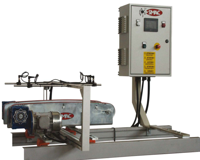
GDM/E - Virador/alinhador de pisos eletrônico GDM/E - Electronic tile turner/aligner
