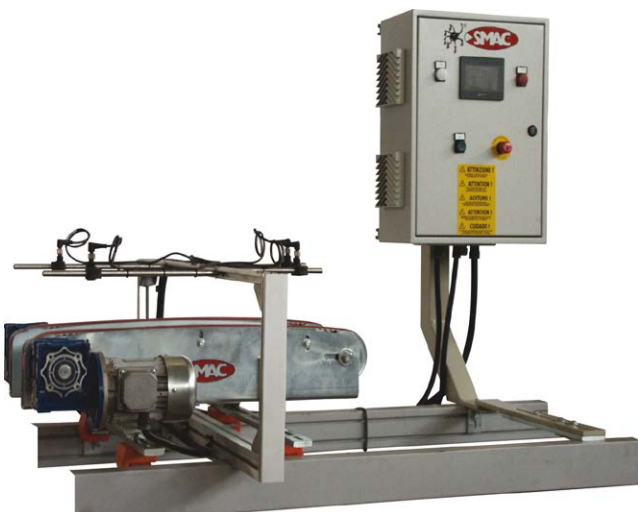
GDM/E - Girapiastrelle/allineatore elettronico GDM/E - Tourne-carreaux/aligneur électronique
