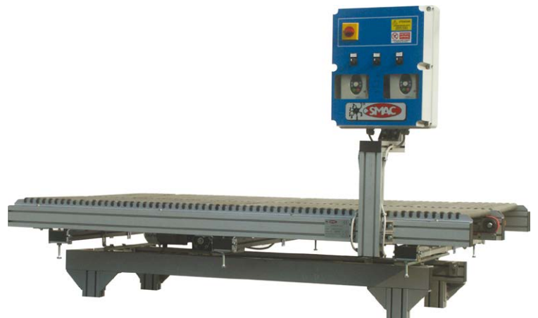
GDR - Girapiastrelle a rulli GDR - Tourne-carreaux à rouleaux
