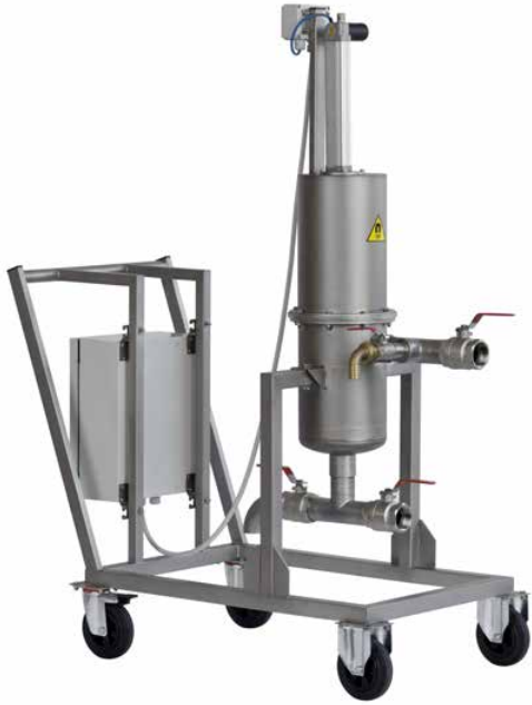
FDA (9000 lt/hr - 13500 Gauss) Auto-cleaning iron remover filter التنظيف التلقائي مرشح مزيل الحديد
