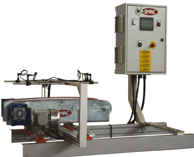
GDM/E - Electronic tile turner/aligner GDM/E - آلة دوران البلاط / تعديل الإلكتروني
